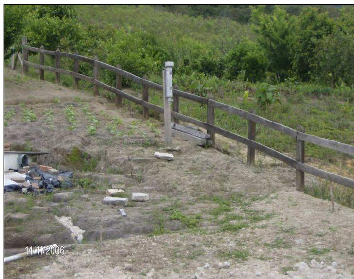
**Figura 7 – Estação Pluviométrica Convencional**
