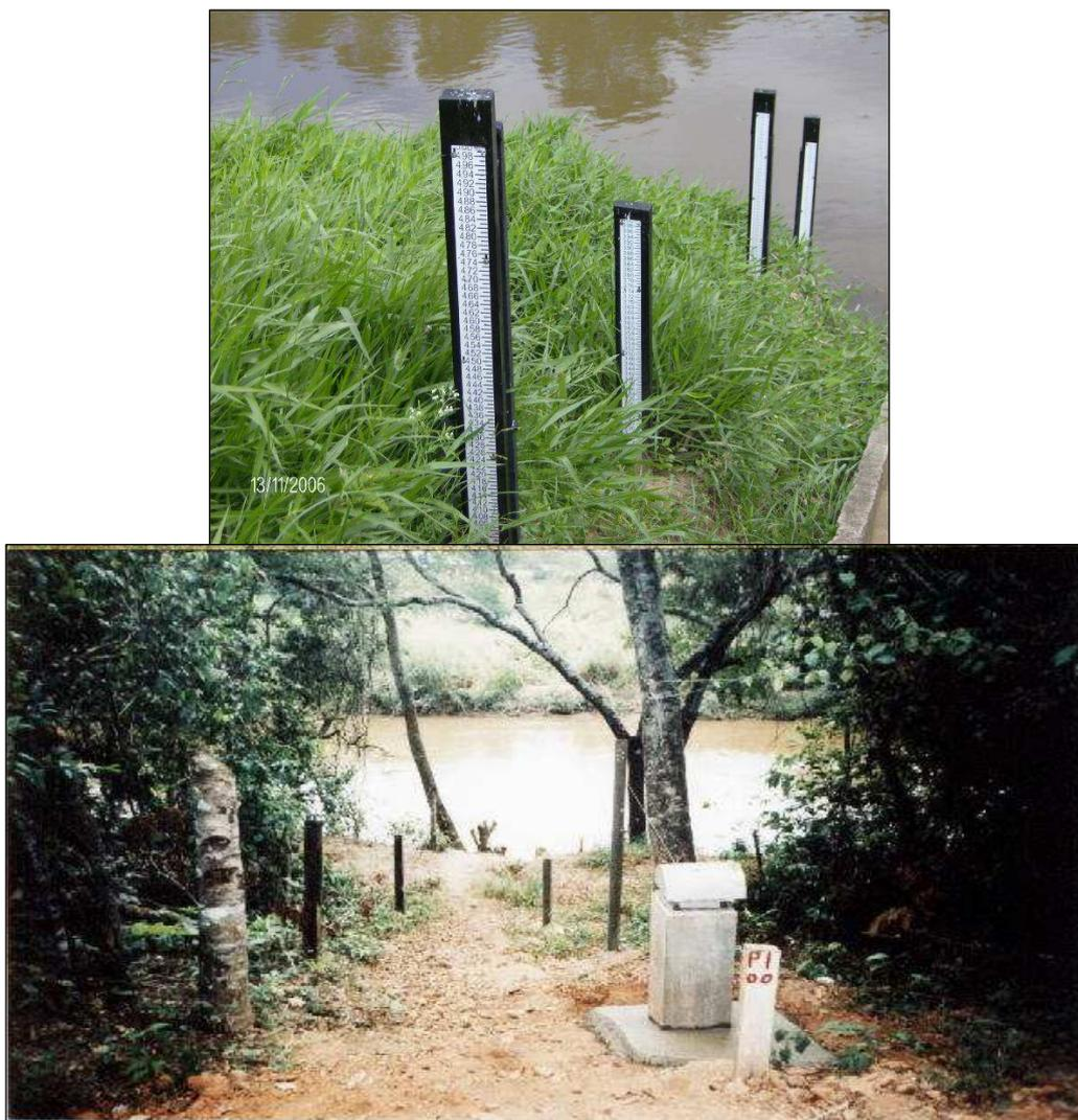
**Figura 10 – Estação Fluviométrica**
