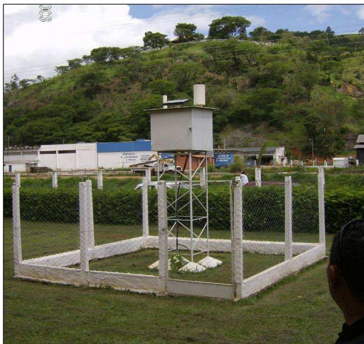
**Figura 6 – Estação Telemétrica ou Automática**
