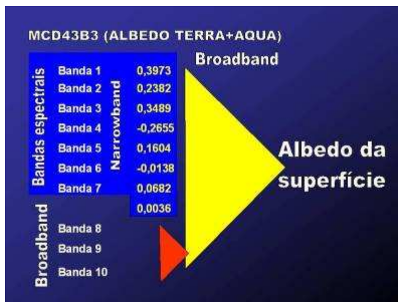
Figura 14 – Fatores de Correção por Banda e Esquema de Cálculo do Albedo de Superfície
