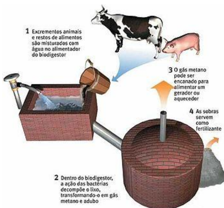
Figura 67 – Forma de funcionamento de um biodigestor.
