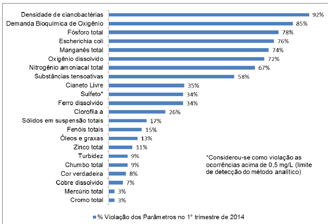
Figura 8: Percentual de violações para os parâmetros na bacia da Lagoa da Pampulha, no 1º trimestre de 2014.
