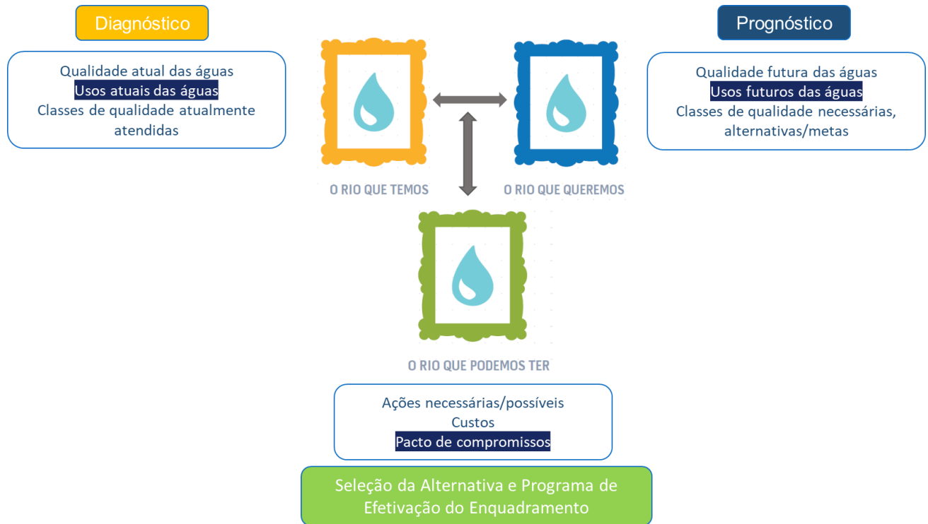
Figura 3.1 – Etapas de Construção do Enquadramento
