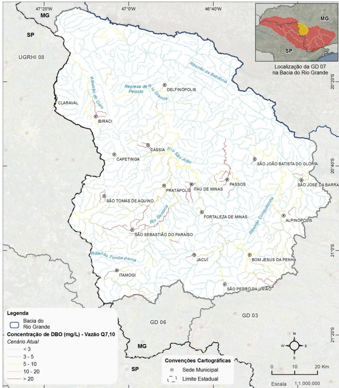
Figura 4.3 – Balanço Hídrico Qualitativo – Concentração de DBO 5,20 e Vazão Q 7,10 na GD 07 – Médio Grande
