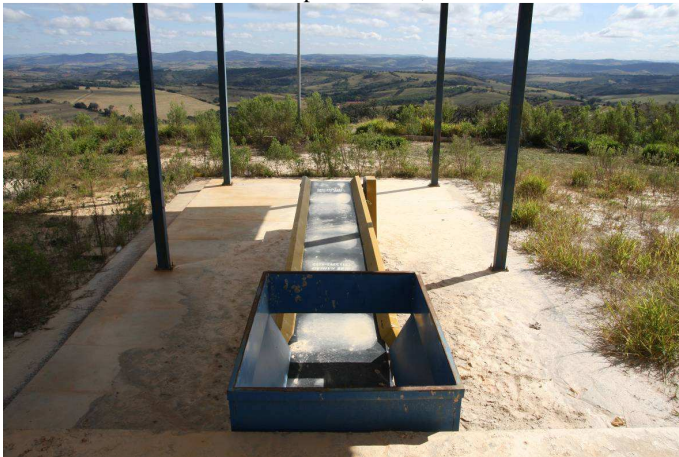
Figura F.173 - Esteira de separação de lixo da UTC de São Thomé das Letras.
