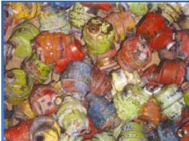
Figura 9.41 - Medidores inoperantes em sistemas de abastecimento público de água. Fonte: PMSS – Ministério das Cidades.
