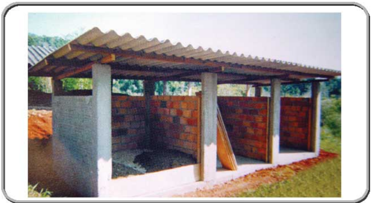
Figura 9.31 -Composteira de carcaças – Fonte EMBRAPA, CNPSA
