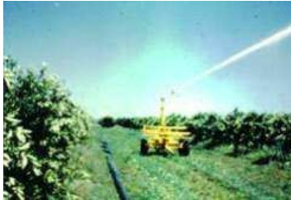
**Figura 69 – Aspersor montado sobre carrinho**
