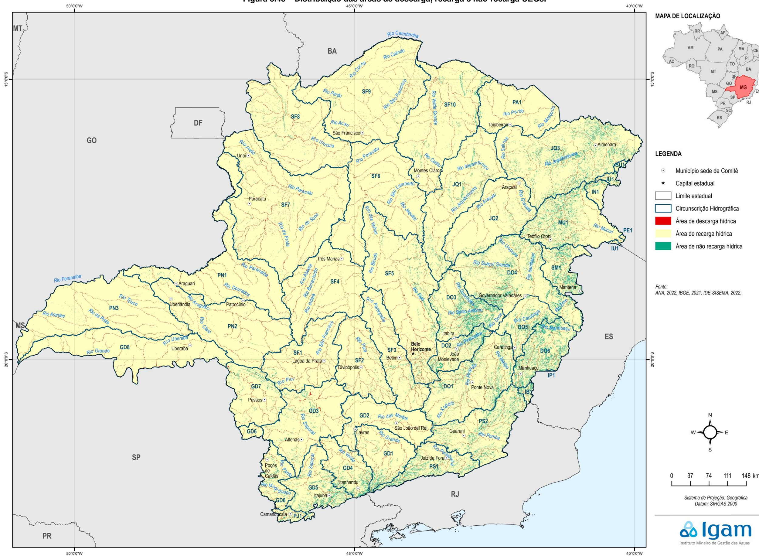
Figura 3.48 – Distribuição das áreas de descarga, recarga e não-recarga UEGs.
