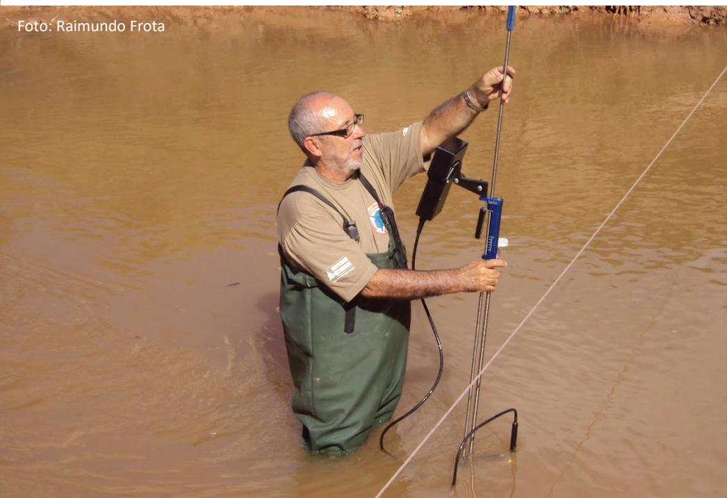
*Hidrometrista do Igam Edson Andrade fazendo medição de vazão com o aparelho Flowtracker.*
