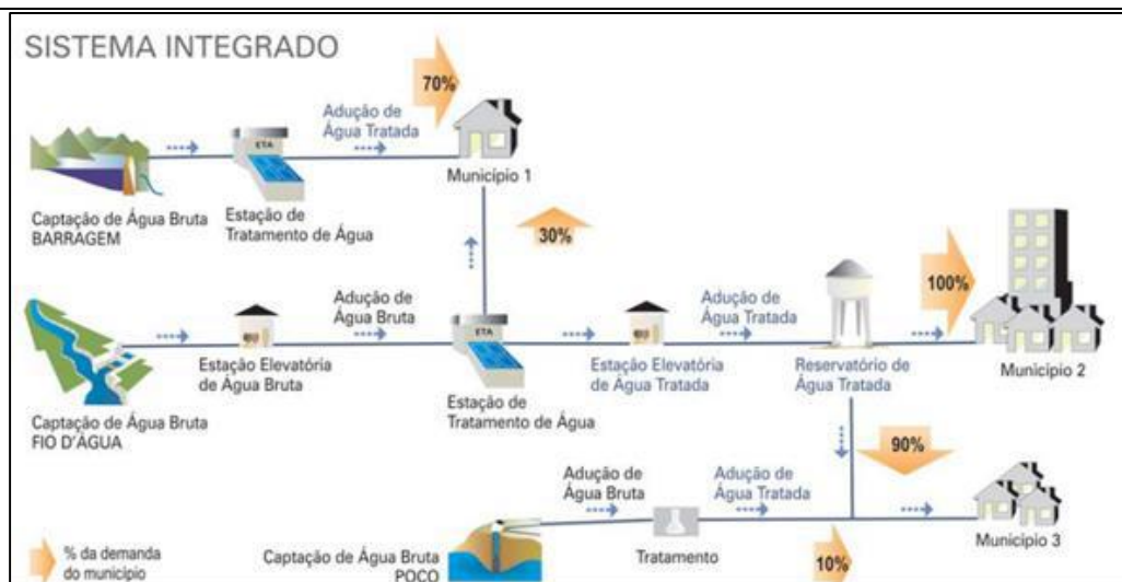
Figura 20 - Esquema de sistema integrado de produção de água
